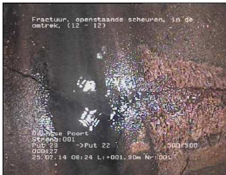
FOTO 001 1.90 m Video DVD01 Fractuur, openstaande scheuren, in de omtrek
