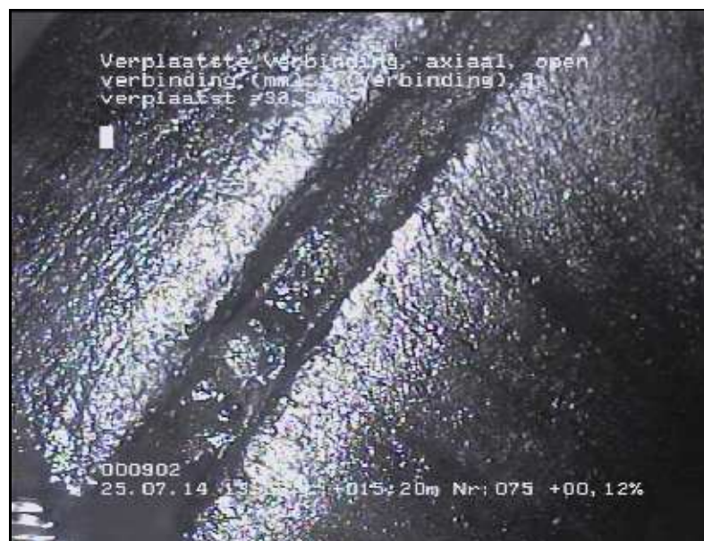
FOTO 075 15.20 m Video DVD01 Verplaatste verbinding, axiaal, open verbinding (mm): 3, verplaatst = 33,90mm
