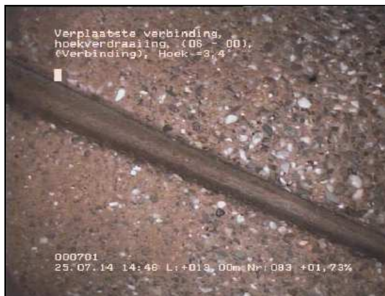
FOTO 083 13.00 m Video DVD01 Verplaatste verbinding, hoekverdraaiing, Hoek = 3,40°
