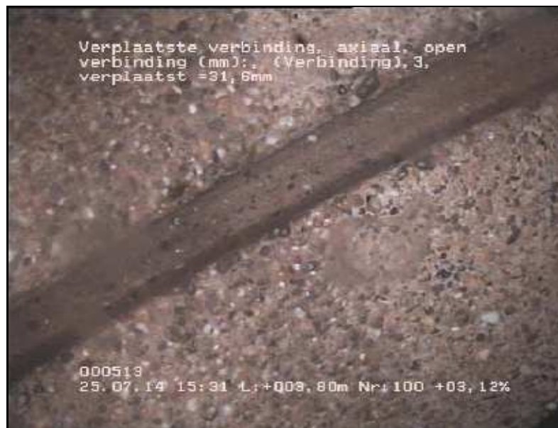
FOTO 100 3.80 m Video DVD01 Verplaatste verbinding, axiaal, open verbinding (mm):, 3, verplaatst = 31,60mm
