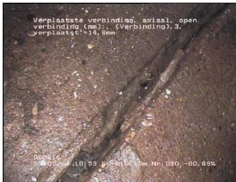
FOTO 030 10.10 m Video DVD01 Verplaatste verbinding, axiaal, open verbinding (mm):, 3, verplaatst = 14,60mm
